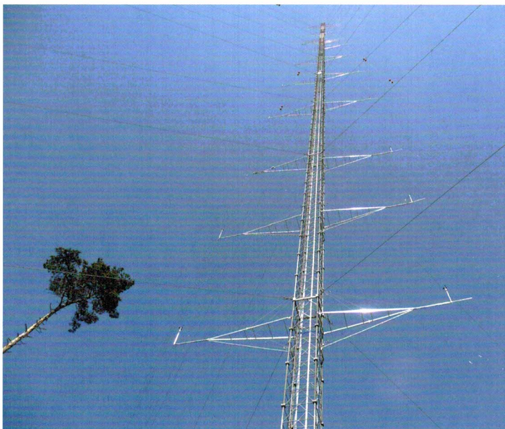
Abb. 1 Der Messmast Rödeser Berg ist 200 m hoch und mit mehr als 40 Instrumenten bestückt.
