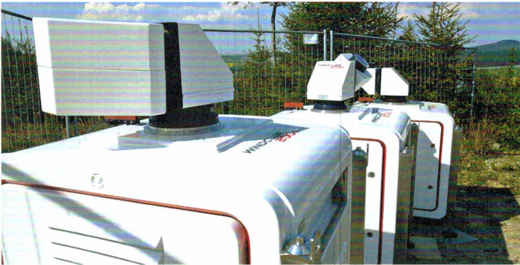
Abb. 4 Die Messwerte dieser LiDAR-Geräte wurden mit den abgesicherten Daten des Messmastes verglichen. Dadurch war es möglich, systematische Messfehler zu identifizieren und Korrekturverfahren zu entwickeln.
